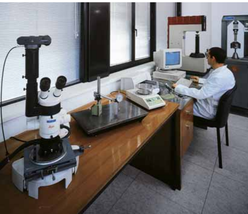
Im Vordergrund: Raumbild-Weitwinkelmikroskop mit Makrographie-Fotoröhre.
