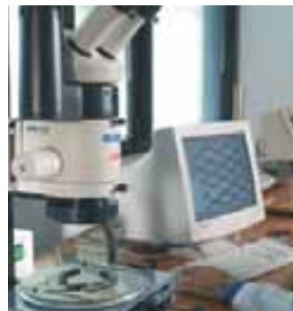
Maßkontrolle mit mikroskopischer und elektronischer Untersuchung der Streckgittermaschine
